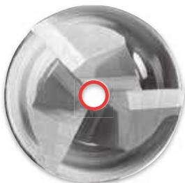
La serie a spigolo vivo KLS-IC presenta un foro centrale per l'utilizzo della lubrificazione interna. Questo consente una migliore e ottimale evacuazione del truciolo nelle lavorazioni gravose, come tasche o figure complesse, dove la normale refrigerazione esterna è ostacolata
